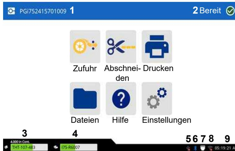
**Anmerkung:** Die Schaltfläche „Schneiden“ wird nur angezeigt, wenn der Schneider installiert ist.
