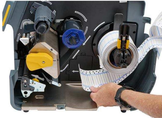
**Anmerkung:** Achten Sie beim Druckdurchgang der zweiten Seite darauf, das richtige Ende des Streifens einzuführen. Dabei gilt: „erster Schrumpfschlauch zuerst“.
