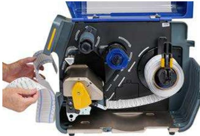
5. Öffnen Sie den Druckkopf mit dem gelben Hebel, entfernen Sie jedoch **nicht** die Rolle mit den Schrumpfschläuchen.
