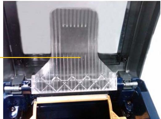
6. Von der Rückseite des Druckers aus führen Sie die Vorderkante des GEDRUCKTEN Streifens durch den Schlitz zwischen Gehäuseabdeckung und dem Druckergehäuse:
