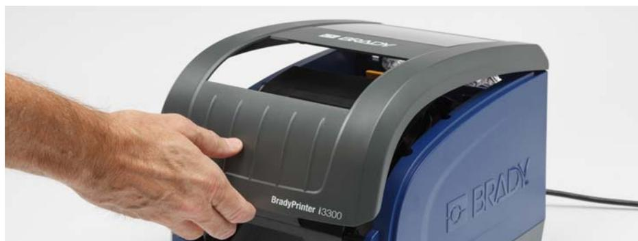
3. Lösen Sie den Riegel auf der Druckkopffür [2] und schwenken Sie sie in die geöffnete Position.
