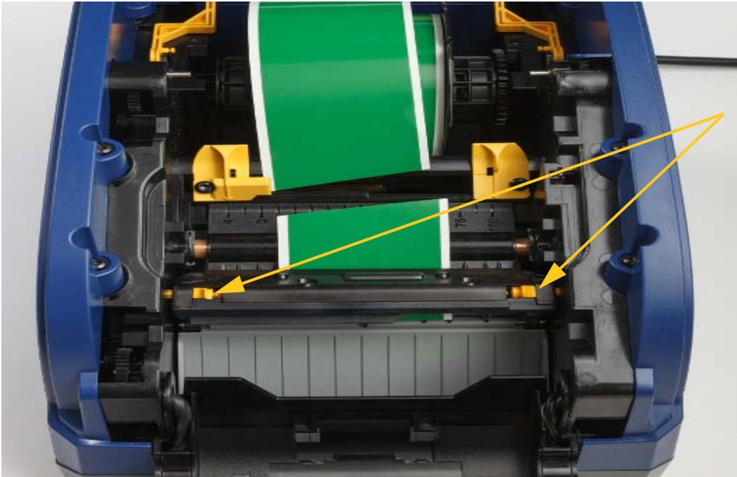
3. Drehen Sie das Zahnrad der Schneidevorrichtung gegen den Uhrzeigersinn, um das Messer herabzulassen.
