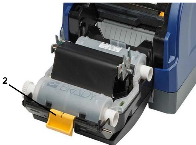
3. Schieben Sie den gelben Medienabstreifer [3] nach hinten, falls dieser verwendet wird.
