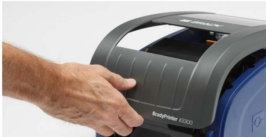
2. Lösen Sie den Riegel auf der Druckkopftür [2] und schwenken Sie sie in die geöffnete Position.
