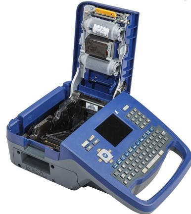
2. Entfernen Sie eine gegebenenfalls vorhandene Farbbandkassette. Greifen Sie die Fingerlaschen auf beiden Seiten der Kassette und ziehen Sie die Kassette aus dem Farbbandfach.
