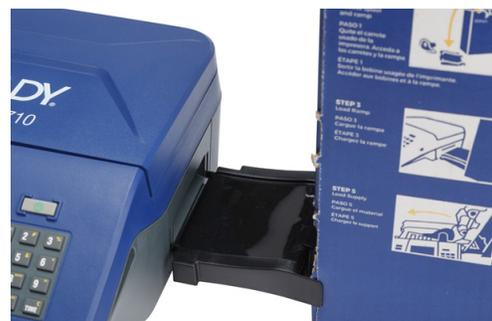
5. Öffnen Sie den Drucker und legen Sie den Etikettenkern ein. Achten Sie darauf, dass die Speicherzelle auf der Etikettenrolle am Lesegerät im Etikettenschacht ausgerichtet ist.
