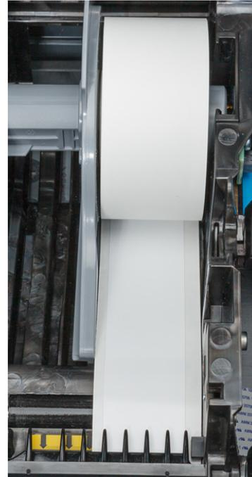
*Abbildung 2-2. Position der Vorderkante des Etikettenverbrauchsmaterials.*
