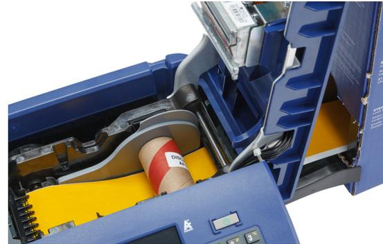
7. Führen Sie die Vorderkante der Etikettenrolle weiter unter den Kern. Führen Sie das lose Etikettenende bis zur schwarzen Linie unter den Rillen ein. Achten Sie dabei darauf, dass das Etikettenmaterial die Sensoren bedeckt und dass die Kante des Etikettenverbrauchsmaterials ungefähr an der Seite des Etikettenschacht ausgerichtet ist. Siehe [Abbildung 2-1](#) und [Abbildung 2-2](#) auf Seite 20.
