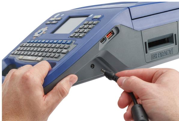
3. Den Stecker am anderen Ende des Kabels in eine Netzsteckdose stecken.
