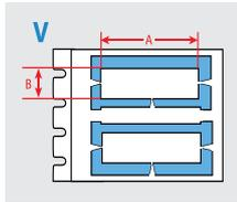
Schrumpfschläuche werden in der Reihenfolge der Höhe und nach der Breite aufgelistet.
