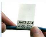
Bringen Sie den bedruckten Bereich am Kabel an.
