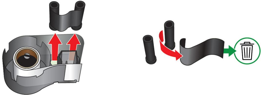
5. Die Etiketten aus dem Etikettengehäuse herausheben und dann den schwarzen Kunststoffzylinder aus dem Inneren des Etikettenkerns entfernen.
