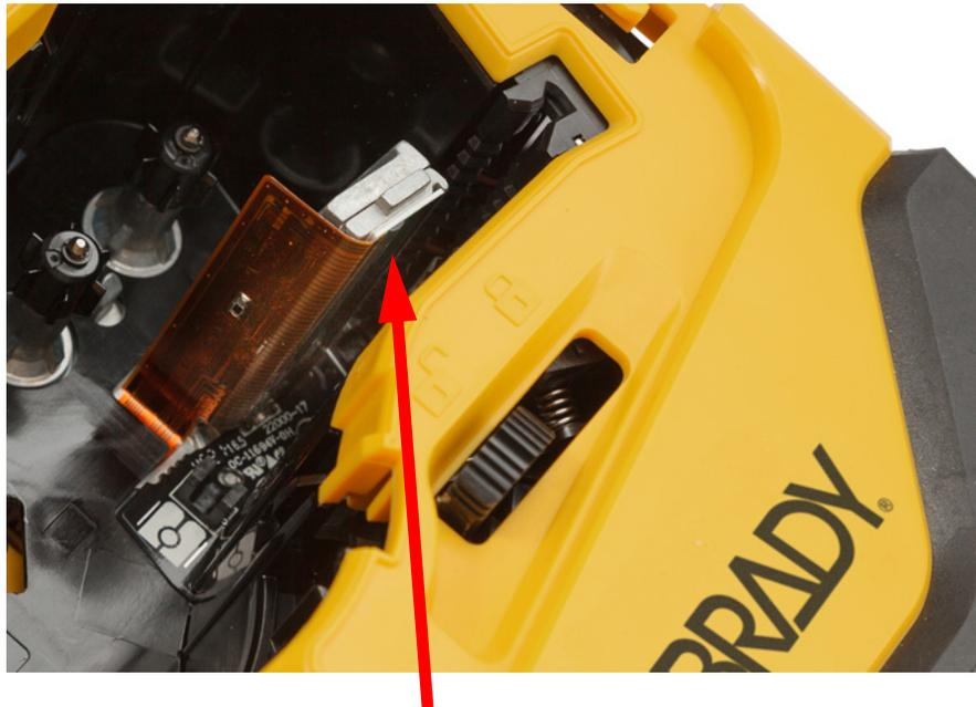
5. Wischen Sie mit demselben Tupfer vorsichtig über die Druckplattenwalze. Schieben Sie den Verriegelungshebel in die verriegelte Position, um auf die Druckplattenwalze zugreifen zu können.
