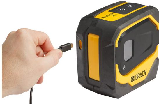
2. Stecken Sie das andere Ende des USB-C-Kabels in den USB-C-Anschluss des USB-C-auf-A-Kopplers.
