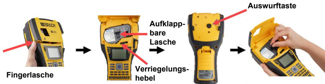
4. Halten Sie die aufklappbare Lasche an der neuen Kassette fest, platzieren Sie die Kassette im Kassettenfach und drücken Sie sanft, bis sie einrastet.
