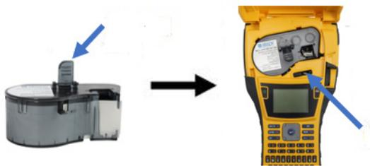
Der Drucker kann zwar mit geöffneter Abdeckung bedient werden; es wird jedoch empfohlen, die Abdeckung nur zum Wechseln der Kassette zu öffnen.
