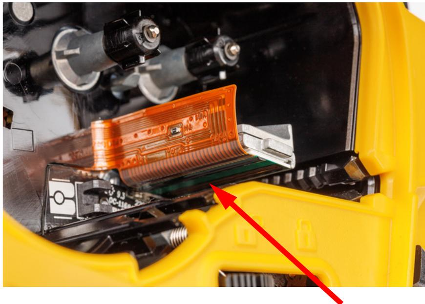
5. Schieben Sie den Verriegelungshebel in die verriegelte Position, um auf die Druckplattenwalze zugreifen zu können.
