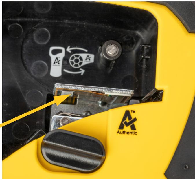
5. Wischen Sie mit demselben Tupfer vorsichtig über die Druckplattenwalze. Möglicherweise müssen Sie den Verriegelungshebel in die verriegelte Position bringen, um auf die Druckplattenwalze zugreifen zu können.
