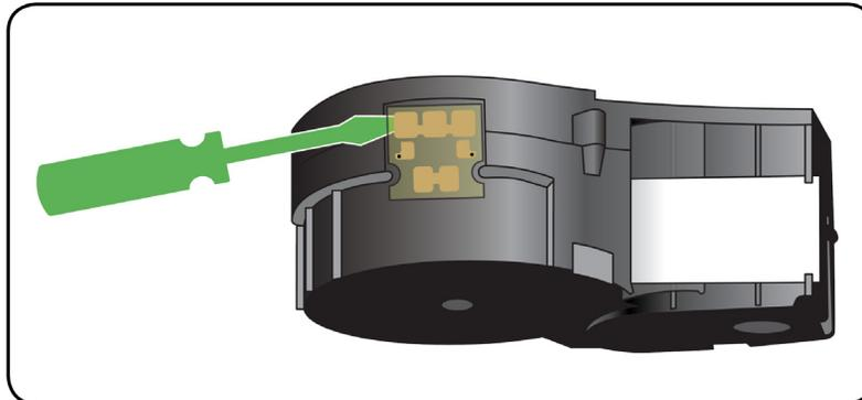
2. Den Flachkopf-Schraubendreher in die Kassettennaht einführen; dabei am schmalen Ende der Kassette beginnen. Dann den Schraubendreher leicht drehen, um die beiden äußeren Gehäusehälften zu lösen. Den Vorgang an verschiedenen Stellen der Naht wiederholen.
