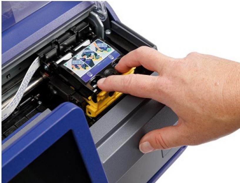
4. Nehmen Sie die neue Patrone aus der Verpackung und ziehen Sie das Klebeband ab, das den Druckkopf abdeckt.
