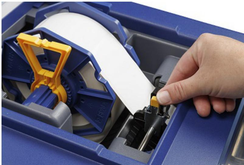
**Anmerkung:** Um sicherzustellen, dass die Etiketten gerade eingeführt werden, muss darauf geachtet werden, die Etikettenrolle schnell in den Drucker zu schieben, bis die gesamte Vorderkante des Etiketts die Zufuhrwalze berührt. Bei breiteren Etiketten beide Hände benutzen, um einen gleichmäßigen Vorwärtsdruck auszuüben, während Sie die Etiketten in den Drucker schieben.
