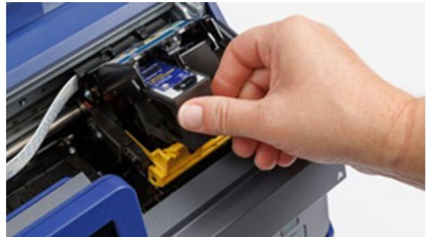
**WICHTIG!** Setzen Sie die Tintenpatrone 1 in Steckplatz 1 und die Tintenpatrone 2 in Steckplatz 2 ein, wie durch die übereinstimmenden Nummern auf den Tintenpatronen und Steckplätzen angegeben.
