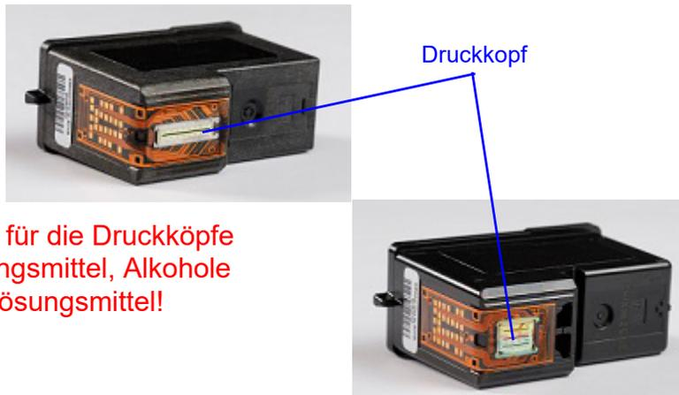
Verwenden Sie für die Druckköpfe **KEINE** Reinigungsmittel, Alkohole oder anderen Lösungsmittel!
