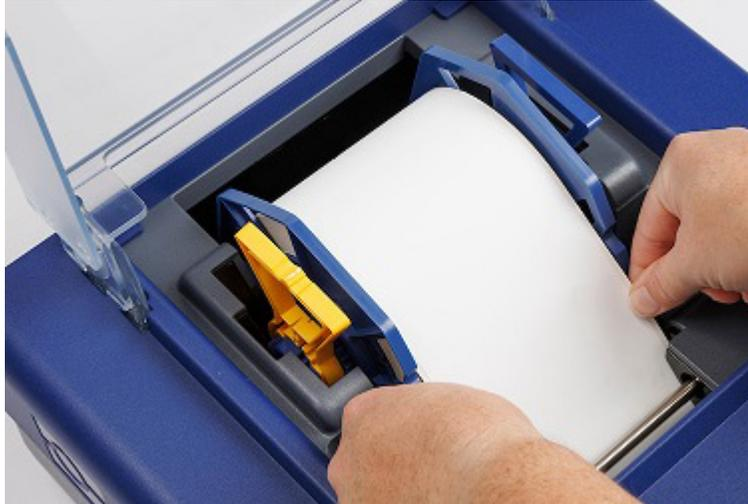
8. Verschieben Sie die Etikettenführung so, dass sie den Rand der Etikettenrolle gerade noch berührt.
