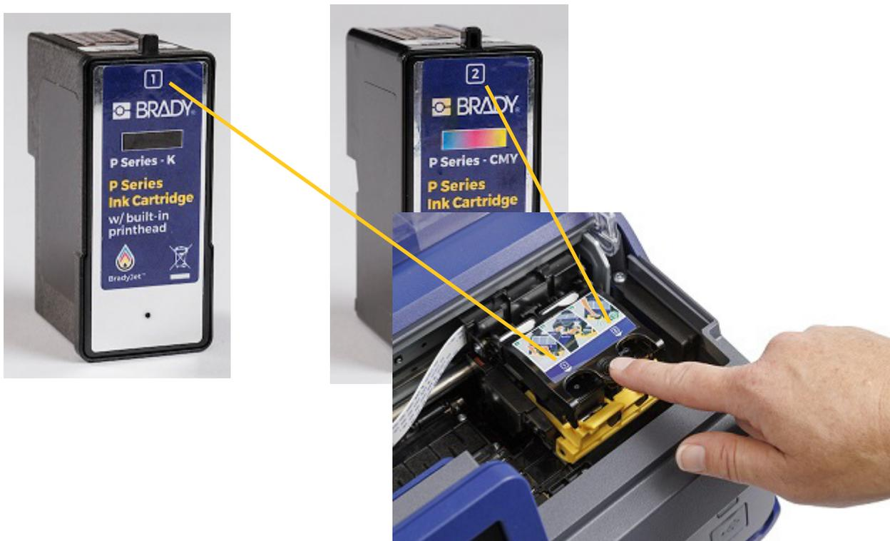
7. Drücken Sie die Tintenpatronenabdeckung nach unten, bis sie einrastet.
