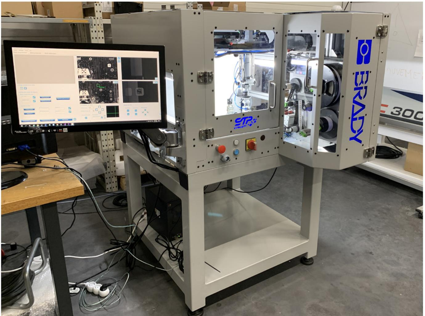
Ein zuverlässiges Traceability-Etikett kann in nur drei Sekunden automatisch gedruckt und an einer beliebigen Stelle auf Standardleiterplatten mit einer oder mehreren Lagen angebracht werden.
