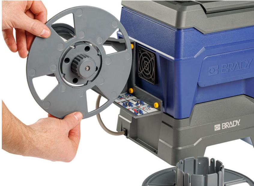
5. Schieben Sie die neue Rolle so auf die Spule, dass die Etiketten unten an der Spule herauskommen.
