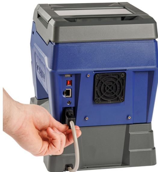
6. Drehen Sie die gesamte Einheit mit der richtigen Seite nach oben und schließen Sie den Drucker an.
