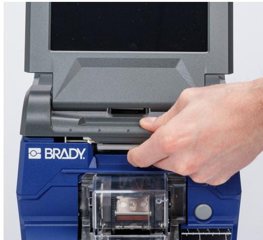
3. Die vorhandene Etikettenrolle entfernen. (Der Drucker wird mit einem im Etikettenpfad installierten Trägermaterial geliefert. Achten Sie auf die richtige Platzierung, bevor Sie es entfernen.)
