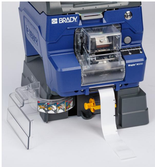
3. Öffnen Sie die Klappe an der Vorderseite der Aufwickelvorrichtung.
