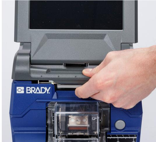
2. Um das vorhandene Farbband aus dem Drucker zu entfernen, drücken Sie die Laschen an beiden Seiten der Farbbandkassette nach innen und ziehen Sie die Farbbandkassette aus dem Drucker heraus.
