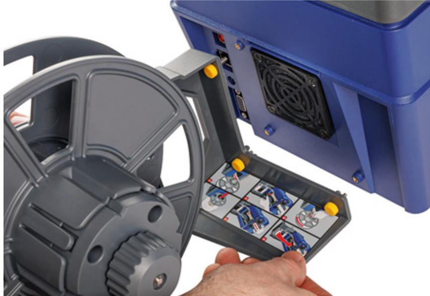
2. Setzen Sie die drei Flügelschrauben ein und ziehen Sie sie fest.
