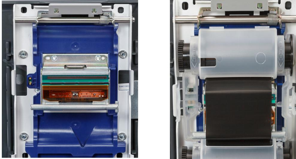
Wenn die Farbbandkassette verwendet wurde, drehen Sie die obere Spule, um das verbrauchte Farbband auf die Spule aufzuwickeln, sodass nur neues, unbenutztes Farbband verwendet wird.
