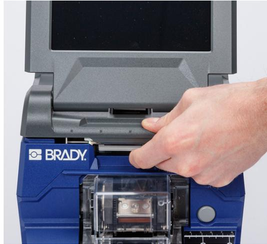
3. Entfernen Sie die aktuell installierte Etikettenrolle. Merken Sie sich die korrekte Platzierung des Etikettenverbrauchsmaterials, bevor Sie es entfernen.
