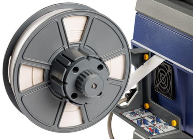
8. Ziehen Sie die Etiketten bis ins Innere des Druckers durch.
