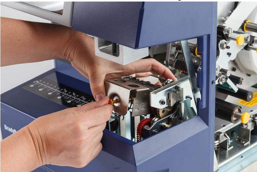
Die vordere Abdeckung wurde entfernt für eine bessere Visualisierung. Es ist nicht notwendig, die Abdeckung zu entfernen, wenn die Blockbaugruppe ausgetauscht wird.
