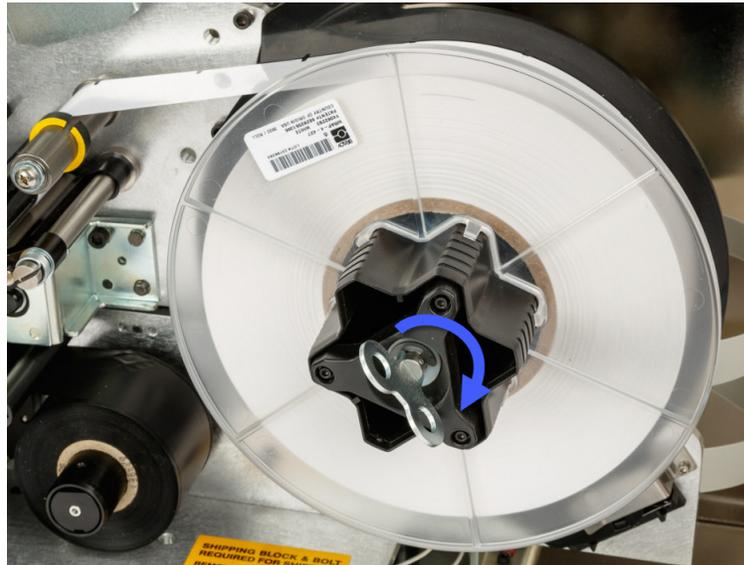
Abbildung 4-3. Etikettenspule spannen
